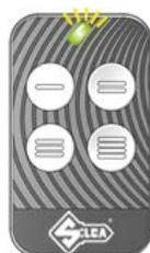
**7-APPUYEZ SIMULTANÉMENT SUR LES BOUTONS 1 ET 2 DE LA TÉLÉCOMMANDE FAAC ET RELÂCHEZ DÈS QUE LA LED COMMENCE À CLIGNOTER. (TRANSMISSION DU CODE SOURCE).**
